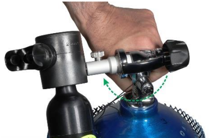
6. Yedek Hava'yı SCUBA silindiri üzerinde duracak şekilde konumlandırın.
