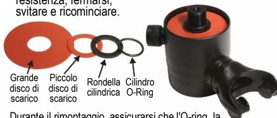
Durante il rimontaggio, assicurarsi che l'O-ring, la rondella e i dischi di scarico siano inseriti nell'ordine mostrato.
