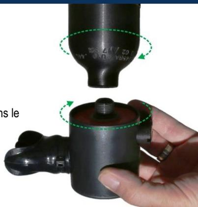
Purger l'air, puis tourner le cylindre dans le sens inverse des aiguilles d'une montre pour l'évacuer
