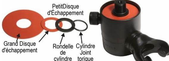
Lors du remontage, assurez-vous que le joint torique, la rondelle et les disques d'échappement sont placés dans l'ordre indiqué ci-dessous.
